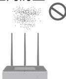
灰尘落在路由器表面会造成静电吸附，使金属接点接触不良。虽然设备本身在防静电方面做了一定措施，但当静电超过一定强度时，仍会对内部电路板上的电子元器件造成致命的破坏，为避免静电影响设备正常工作，请注意以下事项：
